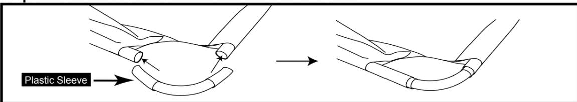
**Step6. INSTALL HORIZONTAL BEAM AND U-TUBES**
