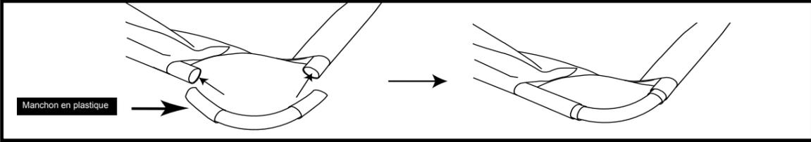
**Étape6. INSTALLER LA POUTRE HORIZONTALE ET LES TUBES EN U.**
